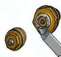
5.4. При течи из-под штока терmostatickogo klapana, головка клапана может быть снята, отремонтирована или заменена. Головка отвинчивается с помощью гаечного ключа. Сливать воду из коллектора при этом не нужно.
